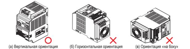
• Обязательно соблюдайте указанные ниже условия монтажа, чтобы обеспечить достаточное пространство для вентиляции и прокладки электропроводки, чтобы не ухудшить охлаждение инвертора.
