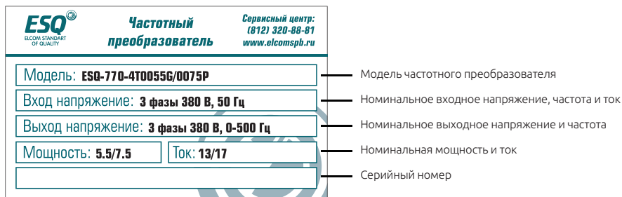
Рисунок 2-4. Изображение шильды частотного преобразователя ESQ-770
